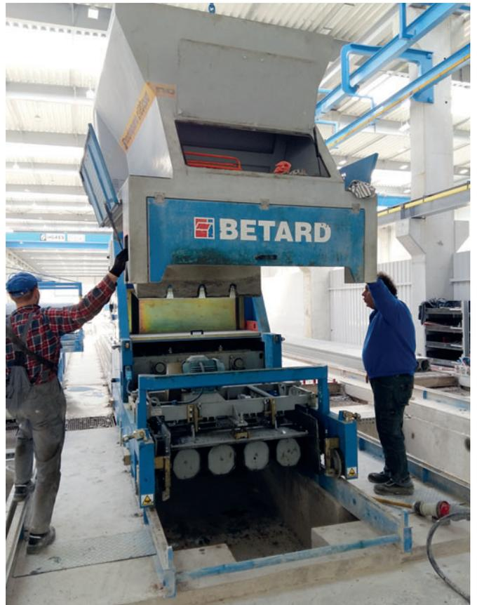
*La unidad tiene un diseño modular: La unidad de suministro de corriente con depósito se puede trasladar fácilmente a otro encofrado para producir una placa de forjado de diferente espesor y/o anchura.*
