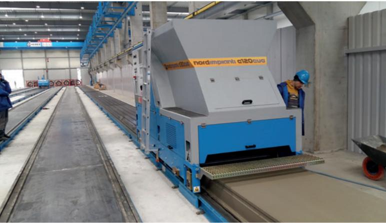
*La máquina de hormigonado de la empresa Nordimpianti, una extrusora de la serie EVO, se desplaza a lo largo de la pista de producción. Paralelamente, en el depósito de la máquina de hormigonado (hasta el final del proceso de hormigonado) debe tener lugar un suministro de hormigón constante y continuo.*
