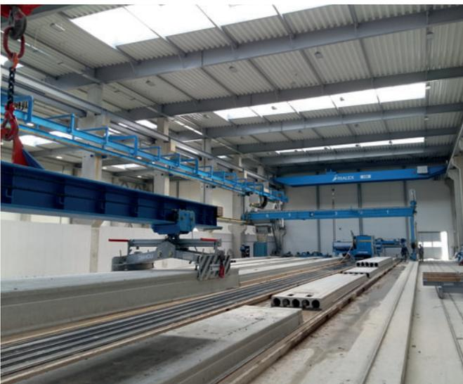
La sierra se mueve a lo largo de la pista de producción y se instala en la interfaz deseada; son posibles cortes transversales, longitudinales y en ángulo.
