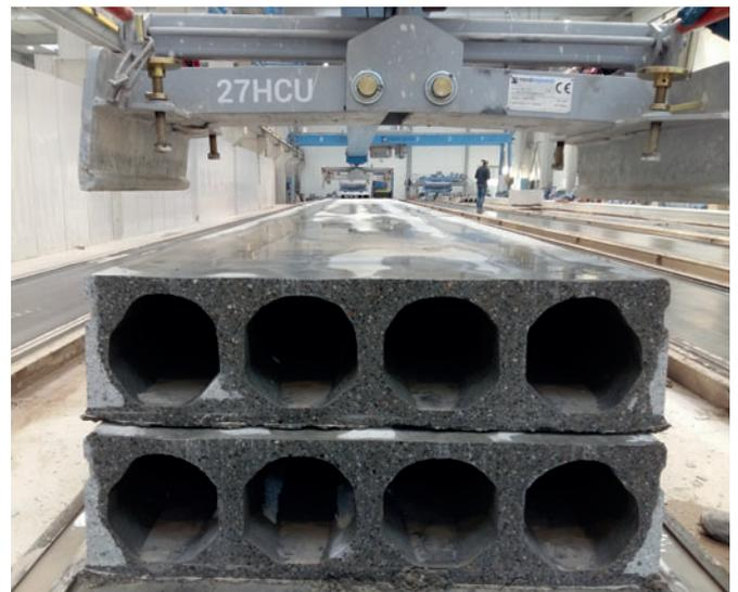
En la planta de Breslavia, las placas con un espesor de 160 mm a 200 mm presentan seis aberturas, con un espesor de 265 mm, cinco y con un espesor de 300 mm a 500 mm, cuatro, como se muestra aquí.
