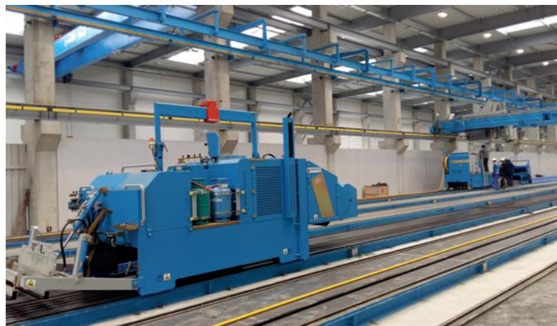
Una máquina multifuncional se encarga de la perfecta aplicación de lubricante; en Breslavia funciona a gas.
