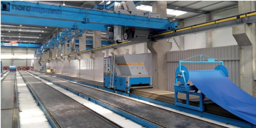
*Un curado específico permite reducir el tiempo necesario para conseguir la resistencia requerida en un máximo de 6 - 8 horas, tras lo cual se alivia la tensión en la armadura y se puede cortar la placa. Durante el proceso de curado específico, los productos deben estar cubiertos con material impermeable al vapor.*
