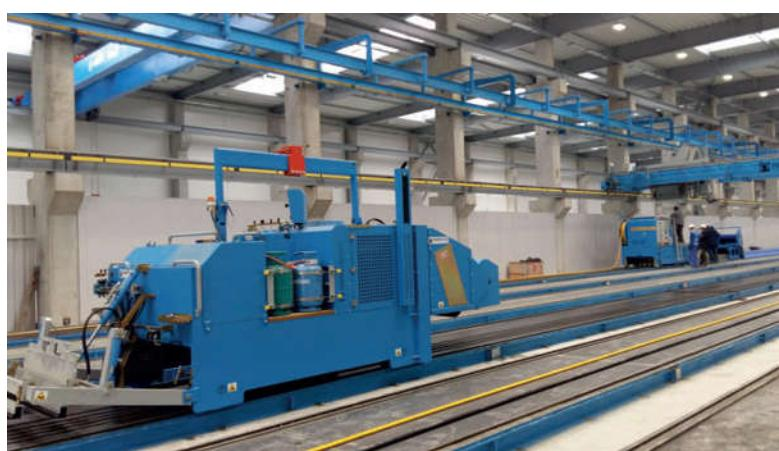
За качество смазки отвечает многофункциональная машина, которая работает на газе
