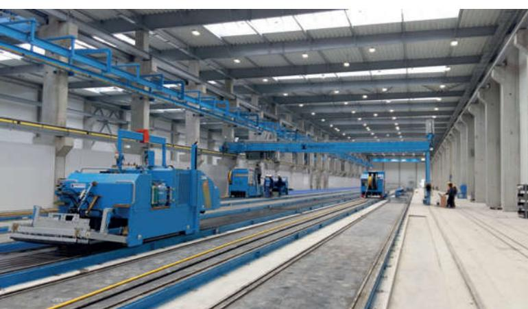
Перед началом нового цикла производства дорожки должны быть тщательно очищены
