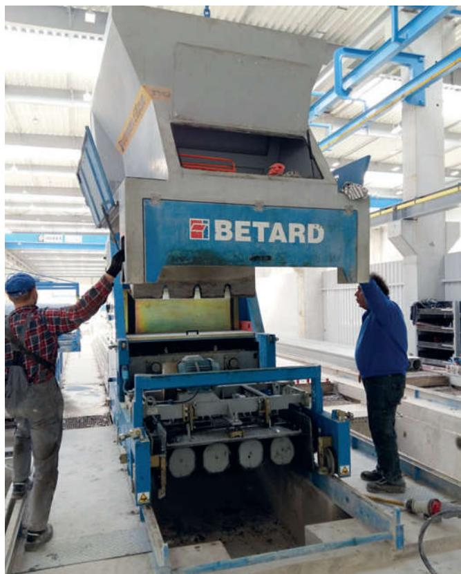
Установка имеет модульное исполнение: силовой агрегат вместе с бункером можно легко переставить на другую формообразующую вставку для производства панелей другой высоты или ширины
