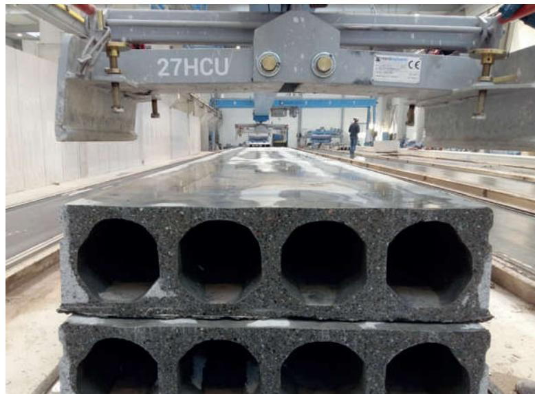
На заводе во Вроцлаве плиты высотой от 160 до 200 мм имеют шесть пустот, высотой 265 мм — пять и высотой от 300 до 500 мм — четыре
