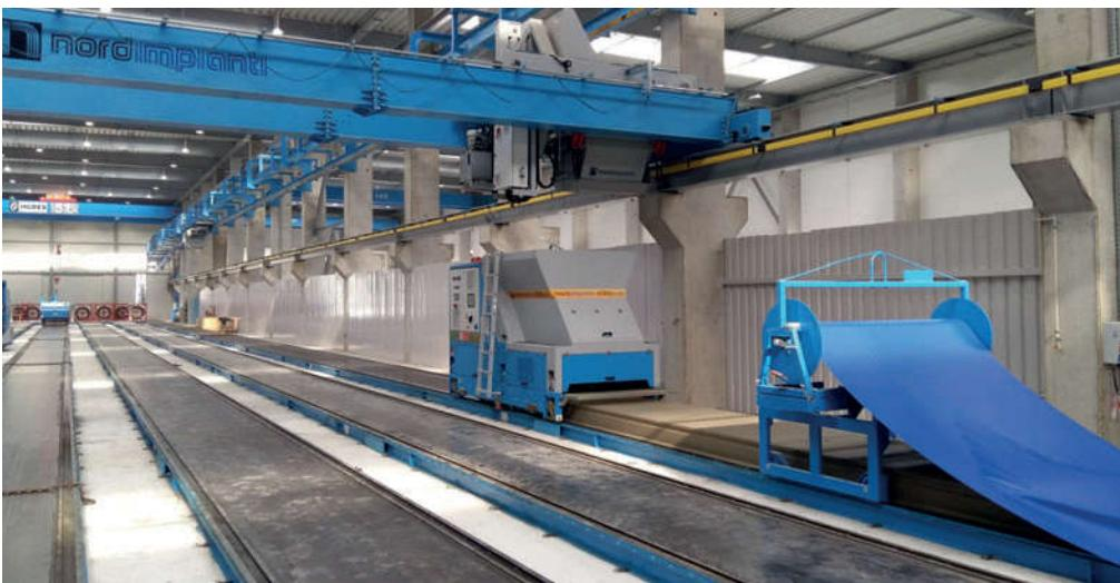
Применение тепловой обработки позволяет сократить время набора прочности до 6 - 8 часов, после чего можно снимать напряжение арматуры и резать изделия. Во время тепловой обработки рекомендуется накрывать изделия паронепроницаемым материалом.
