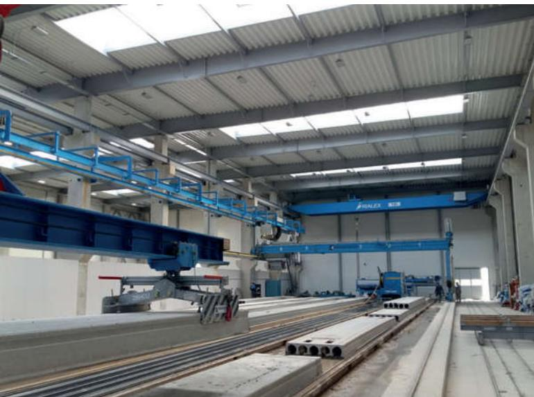
Пила перемещается вдоль дорожки и устанавливается в нужной точке резки; разрезы могут быть поперечными, продольными или угловыми
