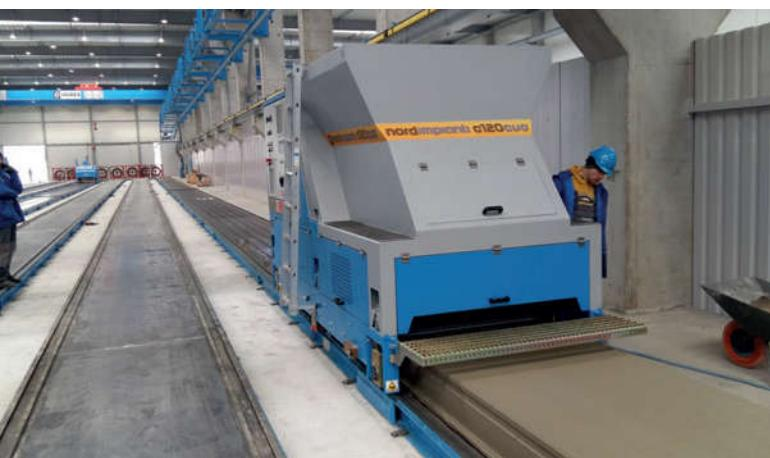
Формовочная машина компании NORDIMPIANTI, экструдер серии EVO, движется вдоль производственной дорожки. При этом в бункер формовочной машины должна быть обеспечена постоянная и непрерывная подача бетона
