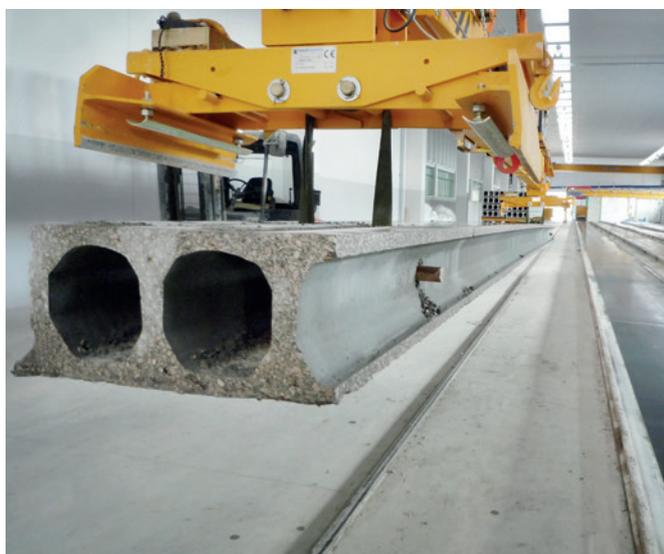
Подъем узких плит с производственных стенов с использованием траверсы
