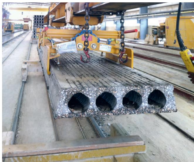
Подъем плиты шириной 900 мм с использованием специальной траверсы
