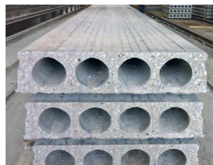
Плита 900 мм, произведенная на экструдере Nordimpianti
