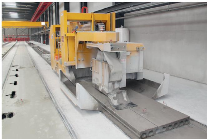
Продольный рез пустотной плиты, осуществляемый универсальной пилой Nordimpianti
