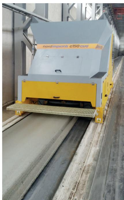
Экструдер во время формирования плиты шириной 900 мм на стандартном производственном стенде шириной 1500 мм.
