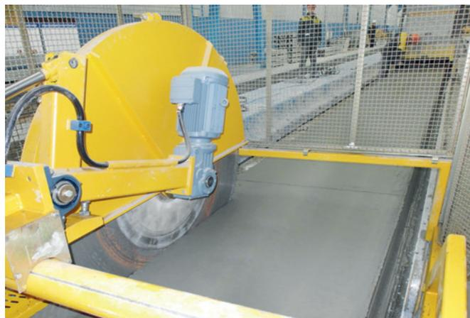
Продольная резка плит по свежему бетону с использованием пилы Nordimpianti
