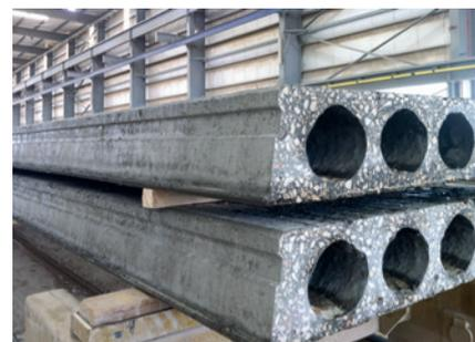
Высокое качество боковой поверхности сохраняется при производстве плиты шириной 900 мм на экструдере Nordimpianti
