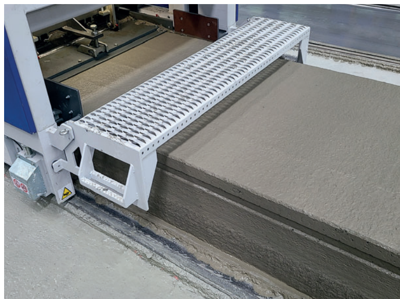
Формование пустотных плит высотой 500 мм
