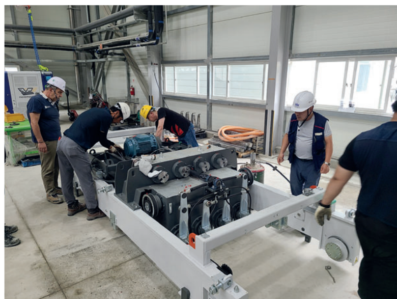
Персонал GPC оценил трансмиссию коробки передач с постоянной масляной ванной
