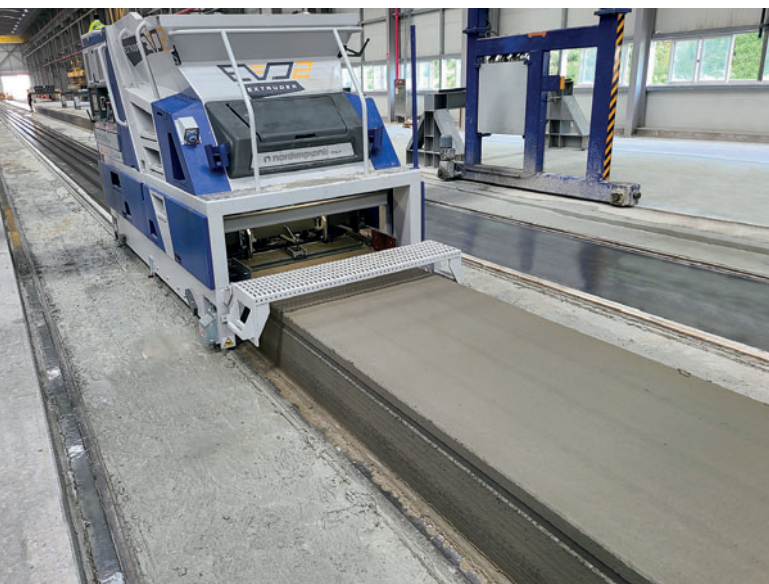
Экструдер EVO2 во время формирования первого слоя пустотных плит высотой 400 мм
