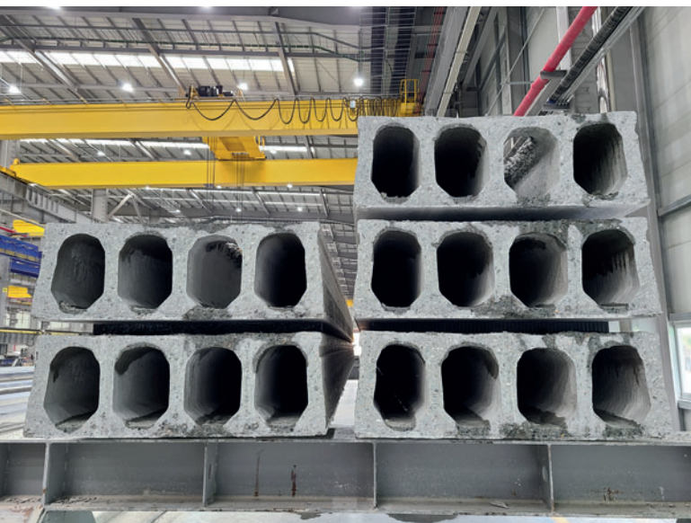
Первые отформованные пустотные плиты готовы к передаче на склад
