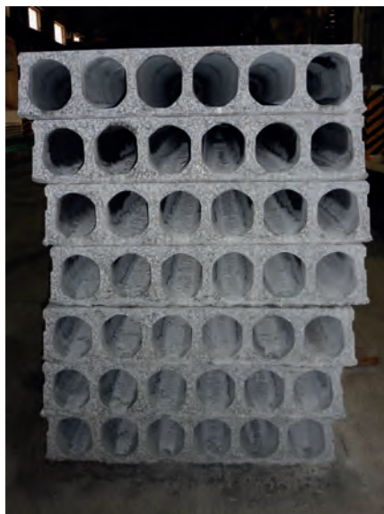
Mediante a extrusora da Nordimpianti, as lajes alveolares protendidas ganham uma elevada estabilidade dimensional.
