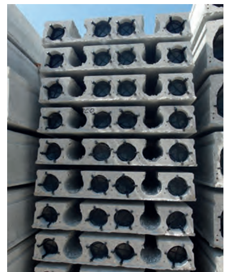
A primeira laje alveolar de concreto protendido H200 mm fabricada pela Extrusora Evo2
