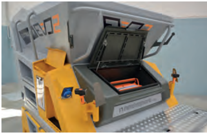
Porta-ferramentas úteis montados no silo
