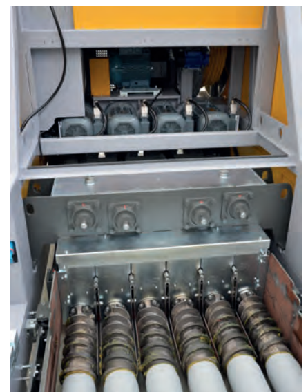
Conjunto de extrusão com motores sem-fim externos independentes
