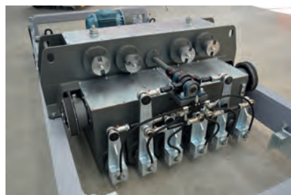
Transmissão selada em um banho de óleo permanente
