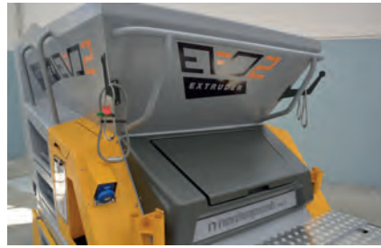
Armazenamento para olhais de içamento montado no silo
