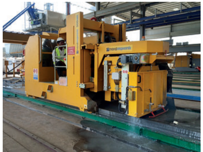
Sega Multi-angolare 500 AM durante il taglio su pista dei pannelli alveolari
