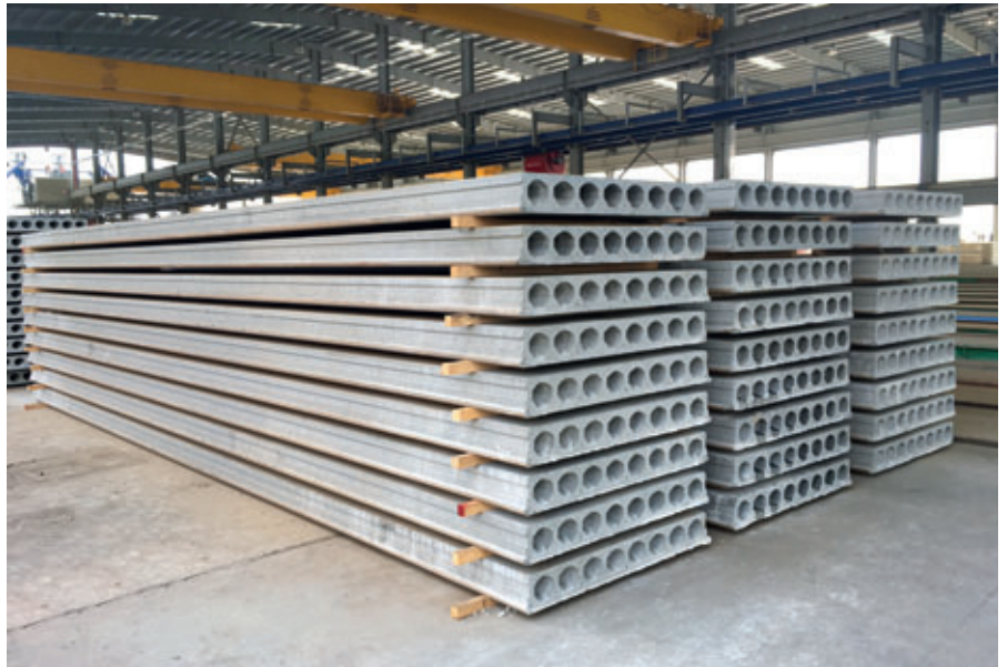
Primi pannelli alveolari H 150 mm prodotti presso il nuovo stabilimento di Jizan con la macchina Extruder Evo Nordimpianti
