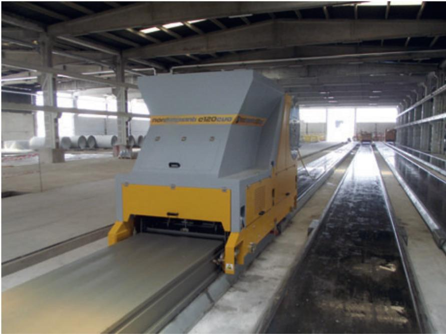
*Elevata compattazione dei pannelli alveolari subito dopo il getto realizzati con una macchina Extruder Nordimpianti*
