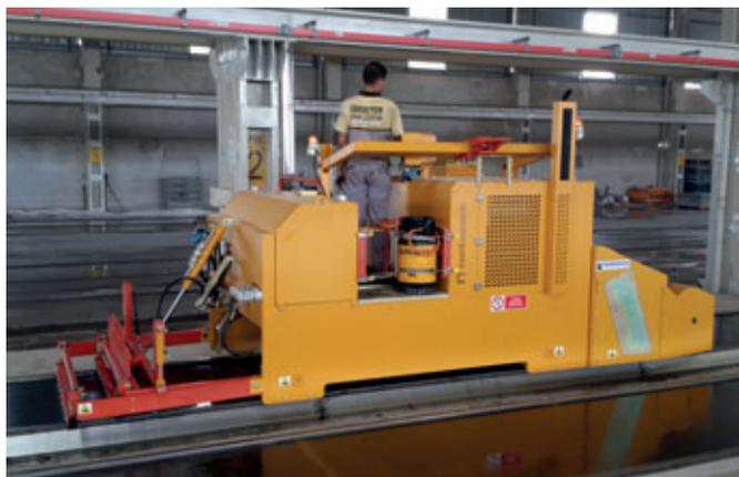
Pulitrice multifunzione durante la preparazione di una pista di produzione
