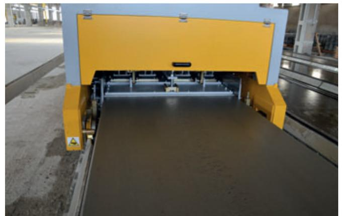
*Macchina Extruder Nordimpianti modello EVO e120 in grado di produrre pannelli alveolari da 150, 200, 265, 320, 400 e 500mm di altezza*
