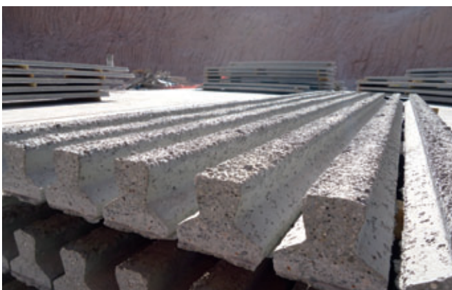
Les premières poutres en T précontraintes de la société Supermix, prêtes à être expédiées aux clients.
