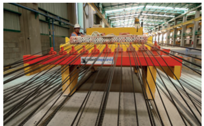
Les fils nécessaires à la précontrainte sont tirés simultanément le long du banc de production avec le chariot de traction de fil.
