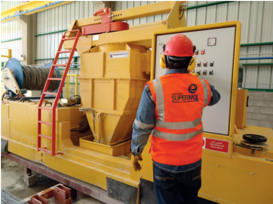
L'opérateur lance le nettoyage de la machine pour préparer le banc au nouveau cycle de travail.
