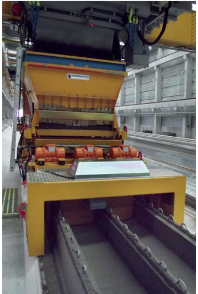
Laje de nervura tripla (Triple Ribbed Slab) durante a produção com a moldadora da Nordimpianti.
