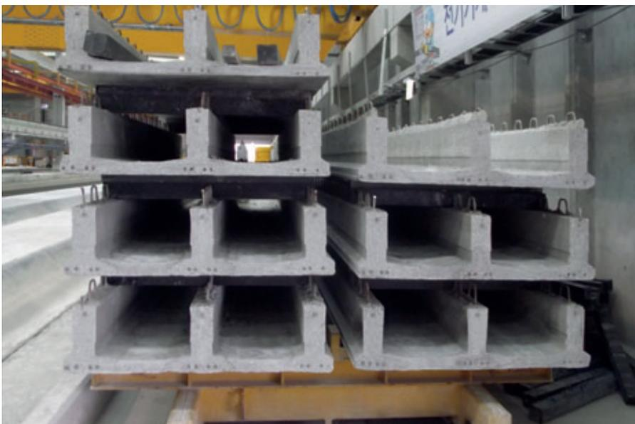
O novo elemento de concreto protendido "Triple Ribbed Slab"
