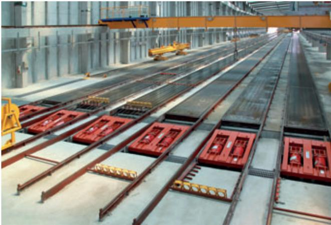
Primeira linha de produção para lajes alveolares com 6 pistas, cada uma com 150 m de comprimento
