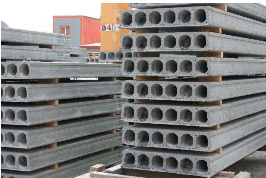
Пустотные плиты шириной 1200 мм, изготовленные на станках 1500 мм
