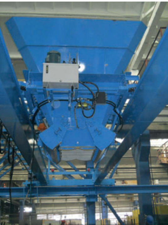
Distribuidor de hormigón para el suministro de hormigón a la extrusora
