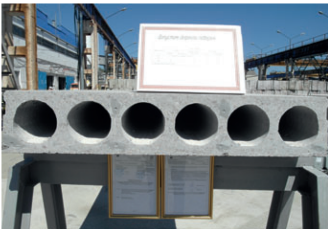
Las nuevas placas alveolares fabricadas aprobaron con creces los ensayos de resistencia y calidad.
