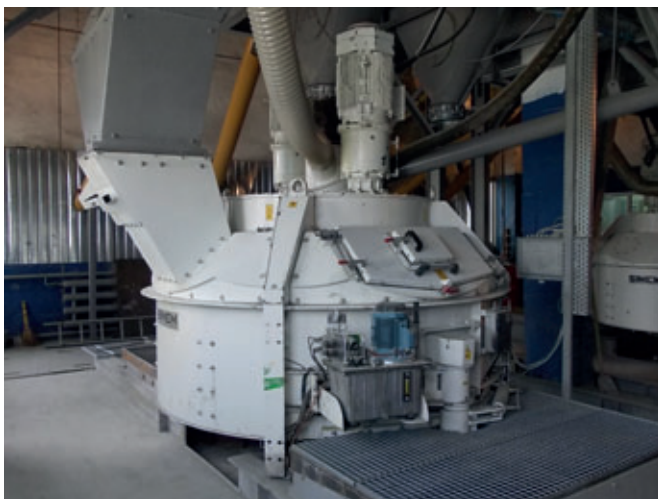
Mezcladora planetaria Xentrix 2500, entrega de 1,5 m³ por ciclo.
