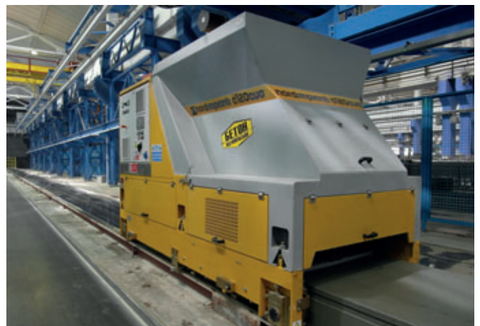
Nueva extrusora EVO e120 de Nordimpianti durante la fabricación de placas H320 mm
