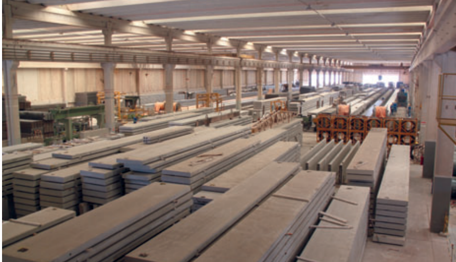
Vista interna del reparto per la produzione di pannelli alveolari
