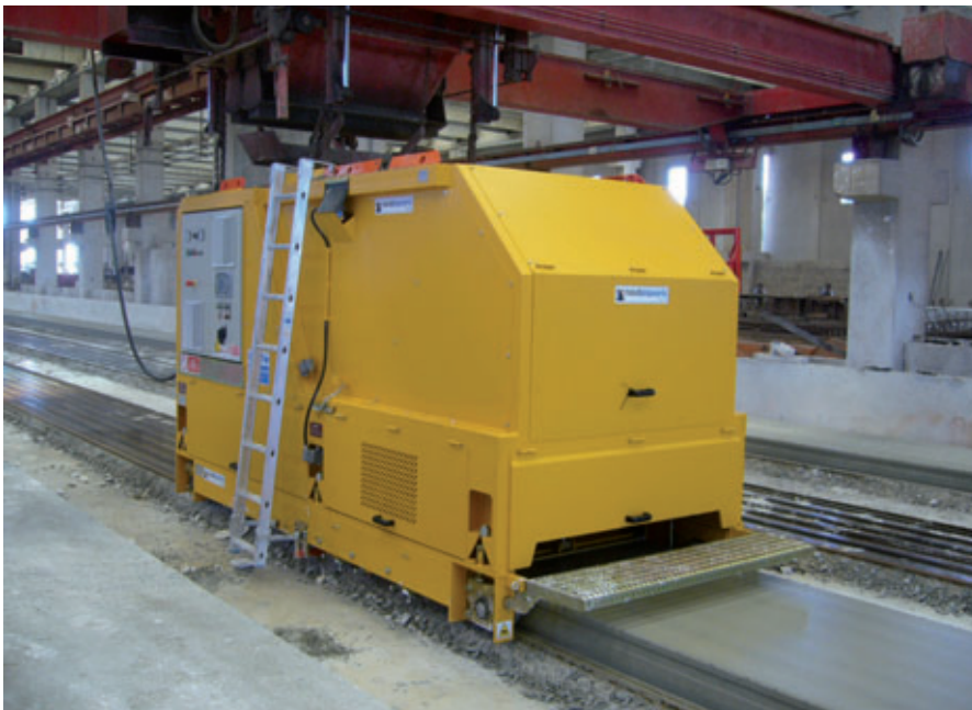
La technologie de l'extrudeuse Nordimpianti en action
