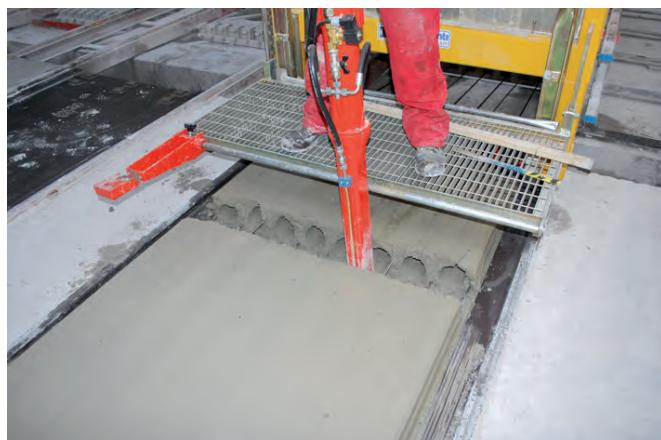
Новый бетонный аспиратор предназначен для удаления полусхватившегося бетона, уложенного экструдером после уплотнения.
