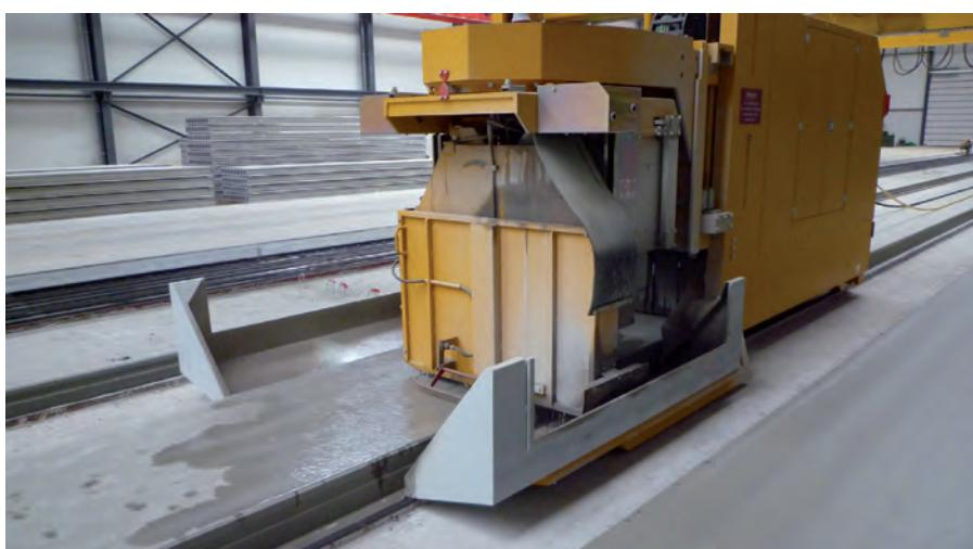
Резательная установка Nordimpianti 500AM способна резать бетонные панели высотой до 520 мм
