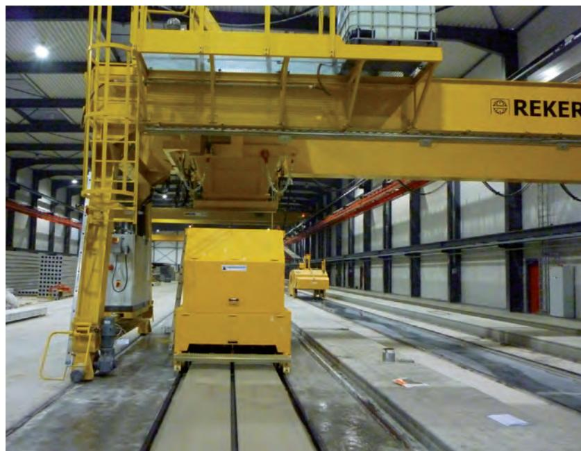
Экструдер Nordimpianti EV2000 способен изготавливать одну плиту шириной 1200 мм или две панели шириной 600 мм.
