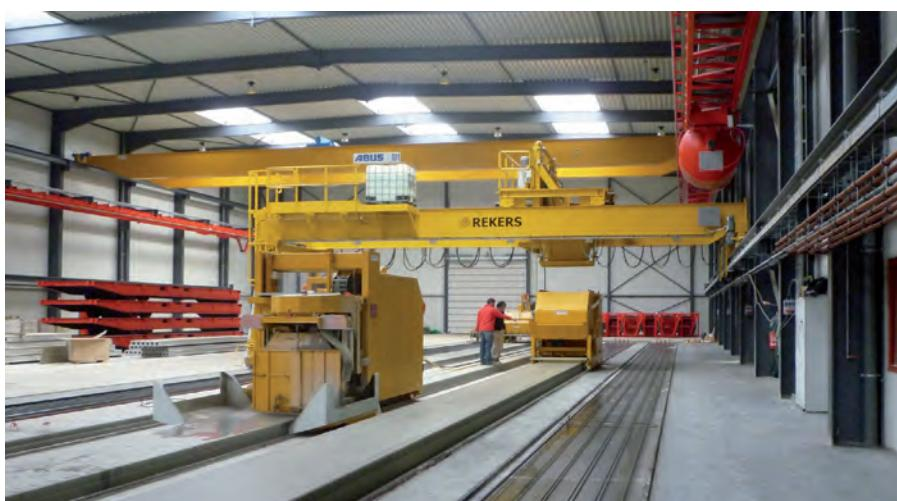
Бетон транспортируется от дозирующей установки к формующим машинам при помощи автоматической системы кубельной подачи, состоящей из подвижного ковша и двух бетоноукладчиков.
