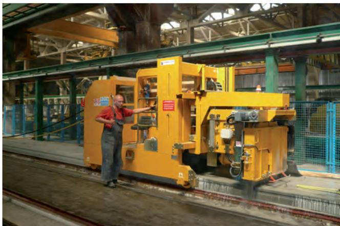
Компания Nordimpianti создала для ЖБИ-5 многофункциональную машину, которая способна одновременно очищать, смазывать и укладывать проволоку на стальные стеллажи, систему для напряжения элементов Multiple pull 250 Top и пилу для резки панелей высотой до 500 мм
