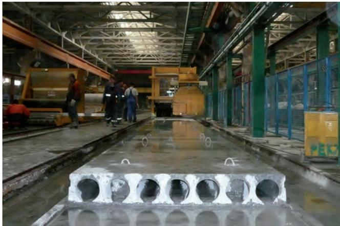
Поверхность "прессованного элемента" гораздо лучше по качеству; кроме того, такие элементы намного прочнее тех, что производятся при помощи других технологий.
