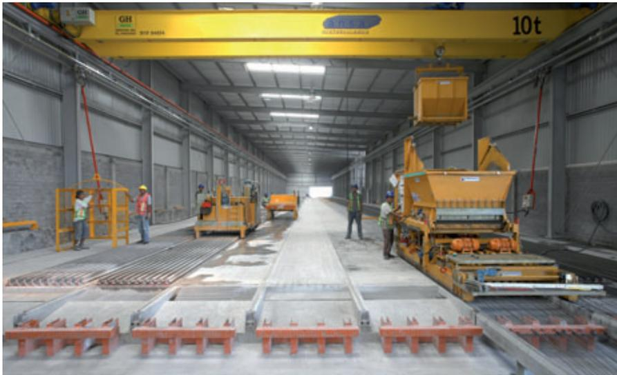
L'entreprise Ansa Prefabricados de Cuernavaca, au Mexique, a mis en service pour la fabrication de ses poutres en T une nouvelle installation utilisant la technologie des coffrages glissants de la firme italienne Nordimpianti
