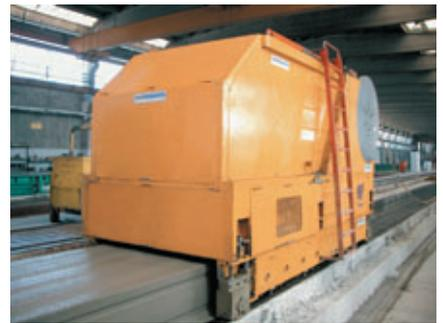
Machine à coffrage glissant (2a) et extrudeuse (2b) Nordimpianti
