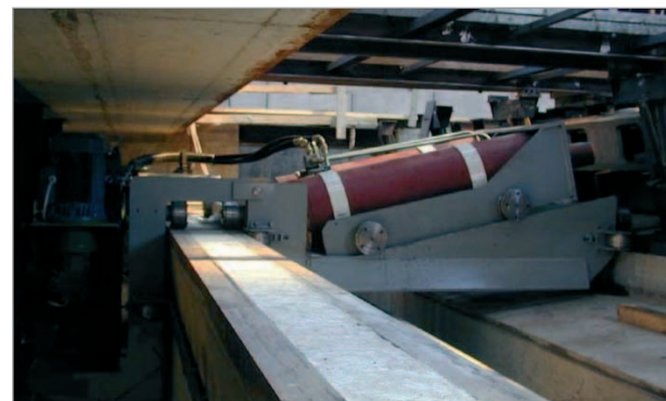
L'unité de précontrainte mobile possède une force de traction pouvant s'élever jusqu'à 500 t
