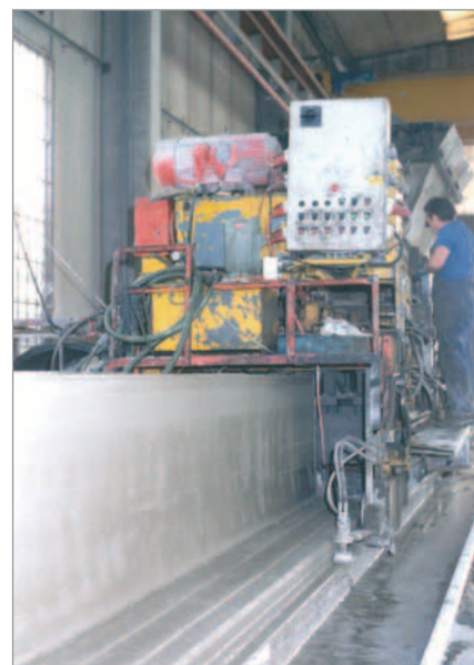
La hauteur des éléments fabriqués peut s'élever jusqu'à 1000 mm
