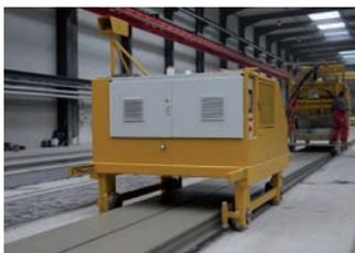
Machine pour le marquage des pièces en béton
