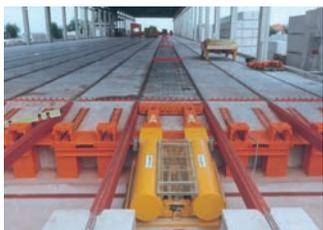
Machine pour la tension des armatures
