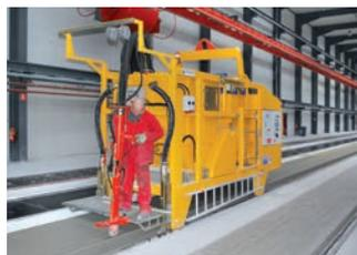
Machine pour l'aspiration du béton frais
