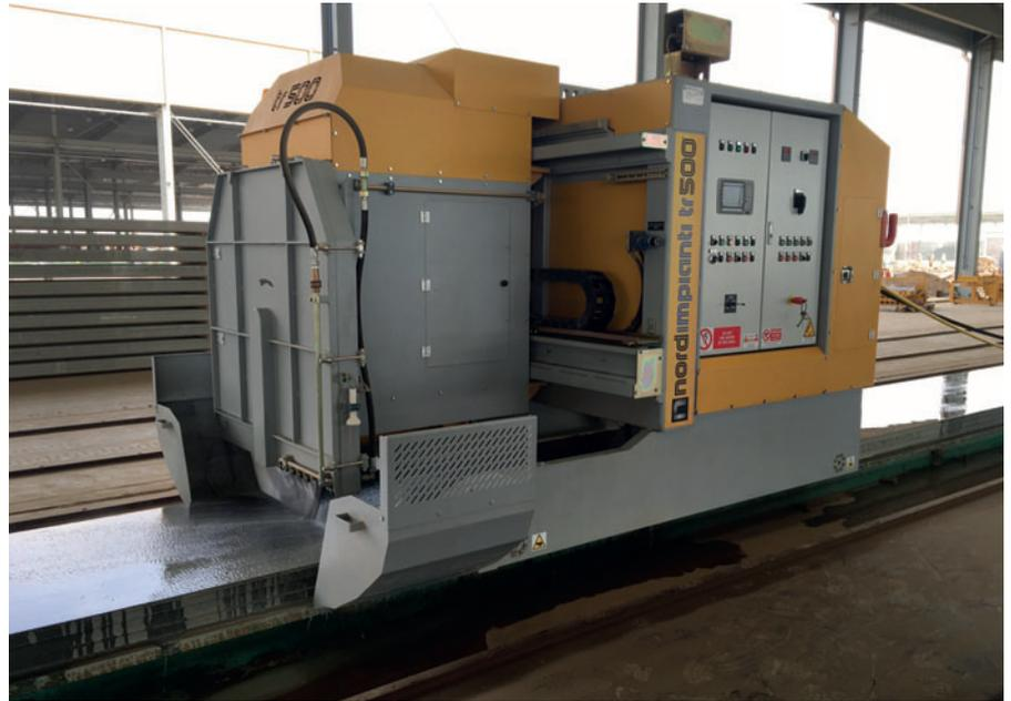
*Sierra automática con dispositivo de posicionamiento láser.*
