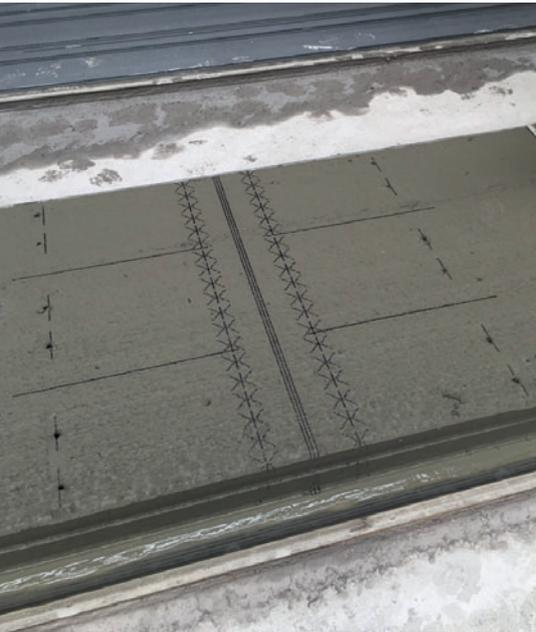
*Ejemplo de una rotulación de los datos de producción realizada con un plóter sobre las placas alveolares pretensadas*
