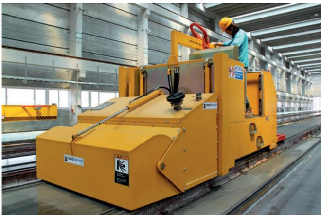
La máquina limpiadora de la pista multifunción durante la limpieza y el lubricación de la pista de producción...
