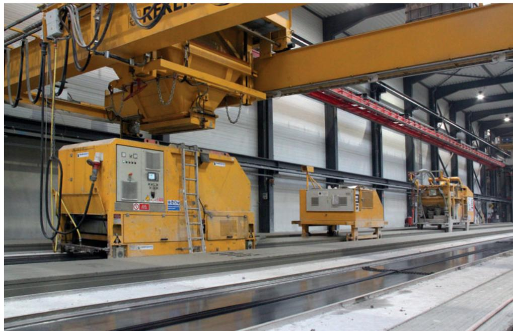
*El proceso de trabajo con la distribución automática del hormigón, la extrusora al hormigonar y un plóter para la trazabilidad del elemento de hormigón listo.*
