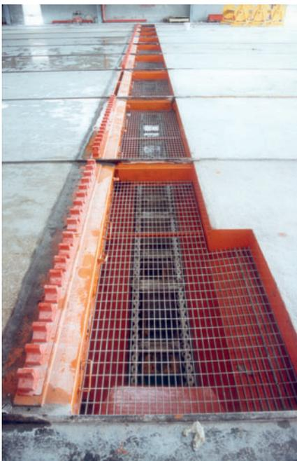
*El transportador de escombros instalado al final de la pista de producción.*
