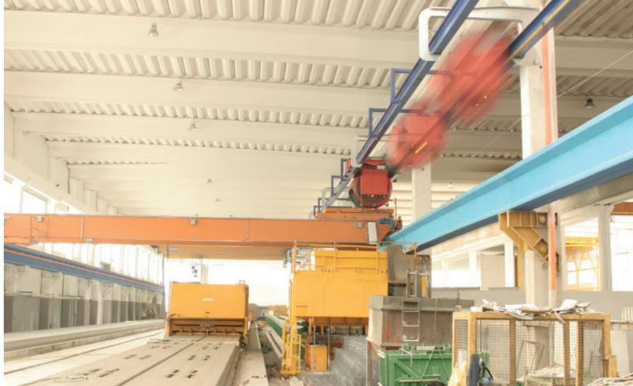
*Una cuba aérea transporta el hormigón automáticamente de la instalación mezcladora a la máquina hormigonadora sobre la pista de producción.*
